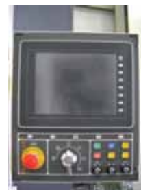
Стойка сенсорного управления ЧПУ
