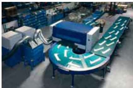
Мобильные подающие и эвакуационные конвейеры
