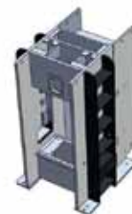
Жесткая станина с общими минимальными зазорами
