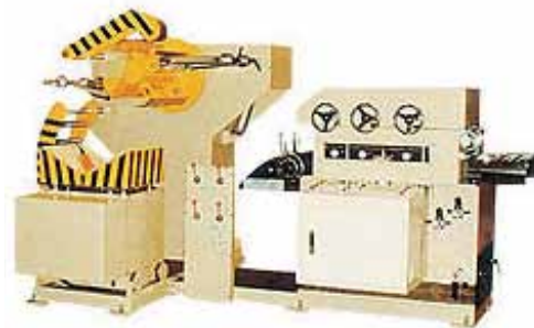
3 в 1 устройство размотки, правки и подачи
