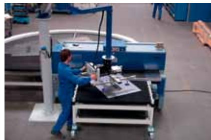
Системы подачи и перемещения обрабатываемых деталей
