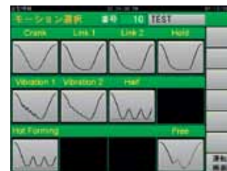
Варианты программирования хода ползуна
