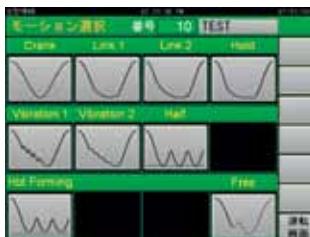
Варианты программирования хода ползуна
