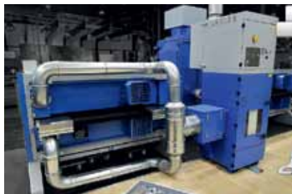
Системы удаления пыли с искрогасителем и влажным пылеуловителем для удаления металлической и алюминиевой пыли
