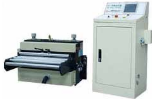
Сервоприводное устройство подачи, синхронизируемое через командо-аппарат с контроллером подачи
