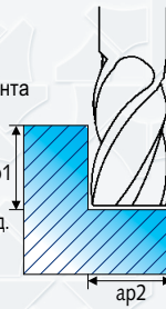
ФРЕЗЕРОВАНИЕ УСТУПА
